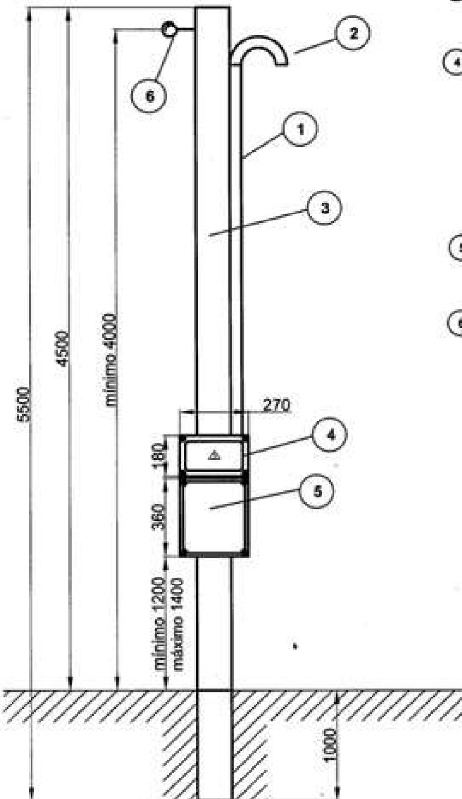
① - Caño para bajada de acometida de PVC de 40 mm de diámetro y 2.4 mm de espesor color gris.
